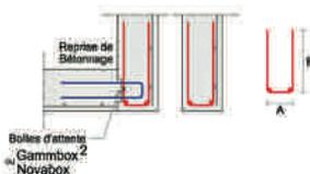
Chainages verticaux « CV » et abouts de voile pour murs en béton banché conformes à l'Eurocode 2-1-1 et son annexe Nationale et au FDP18-717.
