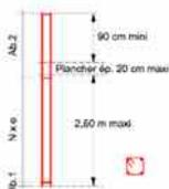
«U» de liaison assemblés complémentaires à emboîter sur les armature « CV » d'épaisseur maximale de 20 cm
